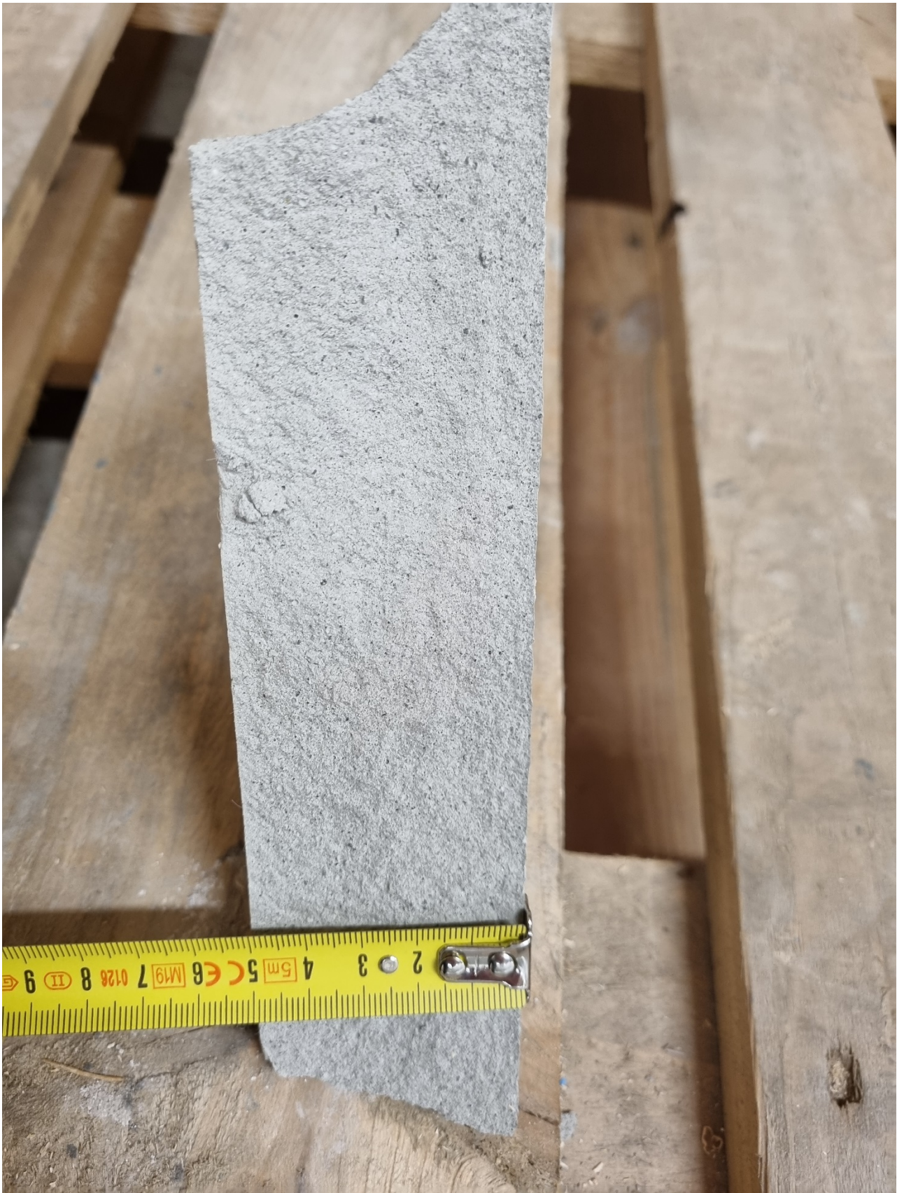
Figur A.4: Avrettingsmasse med tykkelse ca. 50 mm
